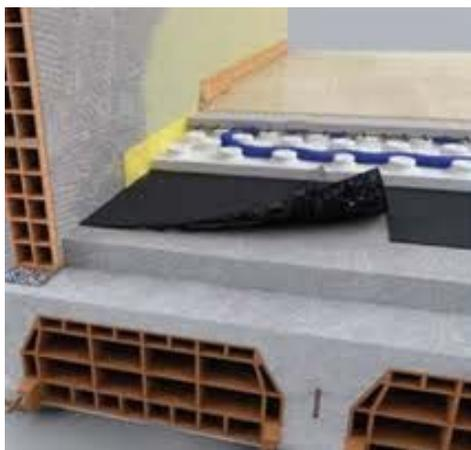
L'isolamento acustico dei solai verrà realizzato mediante la posa di un materassino anticalpestio opportunamente risvoltato sulle pareti così da evitare che i rumori da impatto e da calpestio si propaghino sulla struttura.
