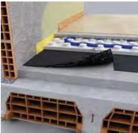
Tutti i solai verranno isolati sia termicamente che acusticamente. L'isolamento acustico dei solai verrà realizzato mediante la posa di un materassino anticalepestio opportunamente risvoltato sulle pareti così da evitare che i rumori da impatto e da calpestio si propaghino sulla struttura.
