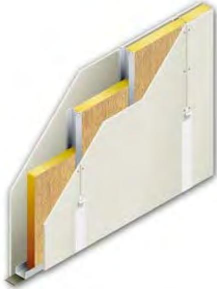
I tavolati interni di separazione dei locali saranno realizzati con una struttura metallica sulla quale verranno applicate delle lastre accoppiate di fibrogesso e cartongesso. L'intercapedine che verrà a formarsi verrà utilizzata per il passaggio degli impianti e verrà riempita con lana di vetro a bassa densità. Le lastre esterne delle pareti a contatto con ambienti umidi saranno del tipo resistenti all'umidità.
